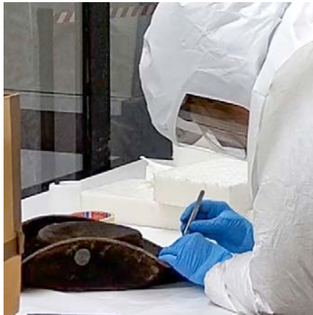
(8) Beprobung der Ablagerungen auf einem Filzhut: Die Ablagerungen weisen einen Arsengehalt von 130.000 mg/kg also 13 % auf.
